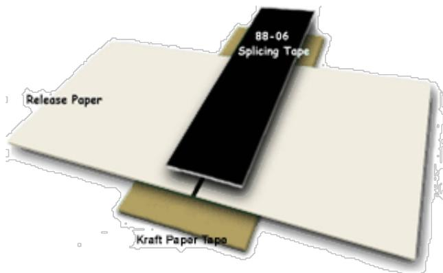
Las cintas disponibles para la unión superior tienen una capa especial de despegue en la superficie para asegurar una separación fácil de la piel sintética y la unión.
